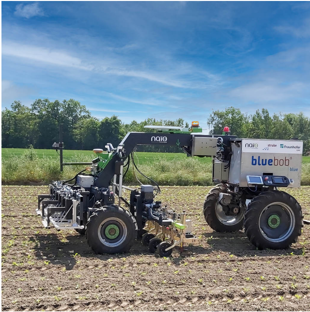
Sechsstufiges Unkrauthacken mit autonom navigierendem Feldroboter.
