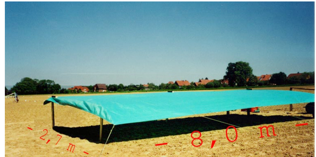
Regendach im zugerollten Zustand während bestehender oder zu erwartender Niederschläge (Sülbeck:153 mm wurden abgefangen und Bernburg: 231 mm wurden abgefangen)
