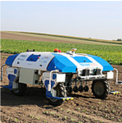
Der BlueBob ein Prototyp für einen elektrisch betriebenen, autonom navigierenden Feldroboter zur mechanischen Unkrautbekämpfung in Zuckerrüben.
