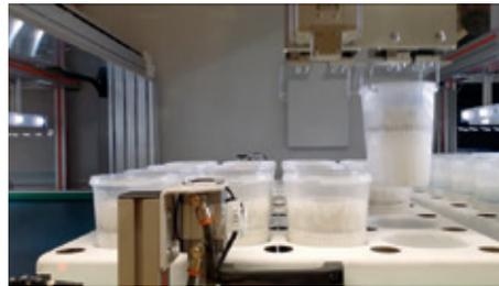
Automatische Zuführung der Proben in das CT-Gerät
