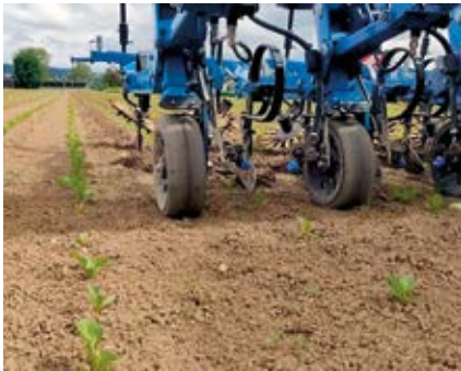
Une lame équerre placée devant le soc à patte d'oie empêche les plantules de betteraves d'être arrachées. (photo : IAG Grangeneuve)
