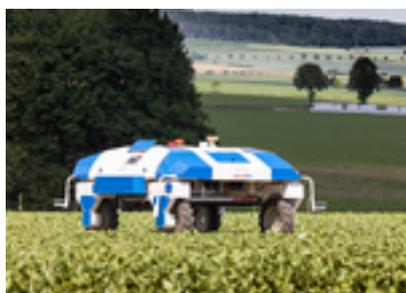
[Translate to French:] De PhenoBob wordt gebruikt om de opkomst van velden te tellen en het bladoppervlak van jonge planten te meten. De robot is volledig autonoom en geautomatiseerd op de proefvelden van suikerbieten.
