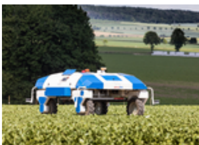
[Translate to French:] De PhenoBob wordt gebruikt om de opkomst van velden te tellen en het bladoppervlak van jonge planten te meten. De robot is volledig autonoom en geautomatiseerd op de proefvelden van suikerbieten.
